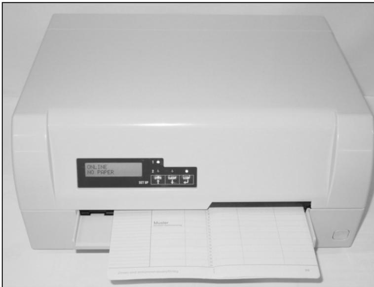
Une fois le livret d'épargne imprimé, il est transporté et sorti automatiquement de l'imprimante puis libéré pour être retiré.
