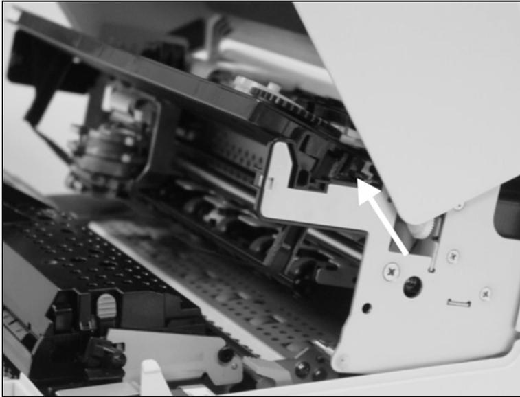
Introduisez la nouvelle cartouche à ruban en l'accrochant d'abord dans les fentes arrière de sa fixation.
