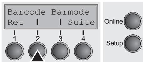
Si cette fonction est activée, l'imprimante a la possibilité d'imprimer des codes à barres et en mode LCP (Large Character Printing = impression d'affiches).
